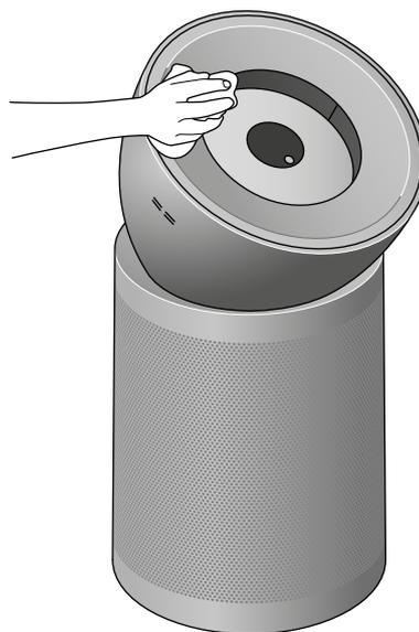
Vérifiez l'absence de poussière et de débris dans les entrées du capteur situées sur le côté gauche de l'amplificateur conique.
