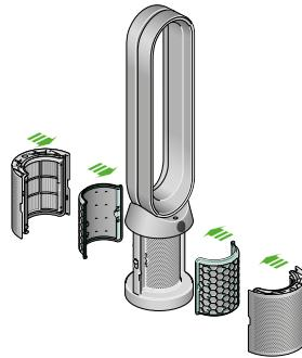
Le ventilateur-purificateur avec les couvercles du filtre ouverts montrant le filtre HEPA situé dans les couvercles du filtre et un filtre au charbon. Les flèches montrent que le filtre au charbon est directement inséré sur la base de l'appareil et les couvercles du filtre devront être insérés sur la base de l'appareil.
