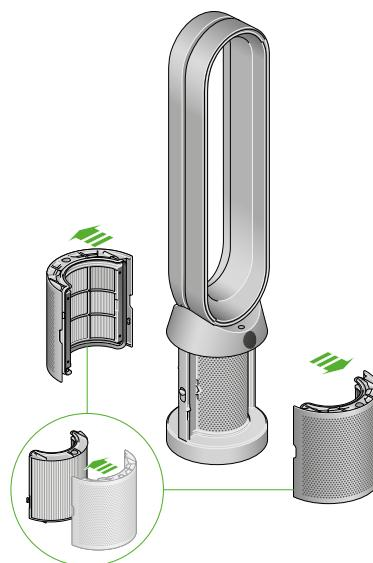
Le ventilateur-purificateur d'air avec les couvercles du filtre ouverts montrant le filtre HEPA+charbon situé dans les couvercles du filtre. Les flèches montrent que les couvercles du filtre devront être installés sur la base de l'appareil.
